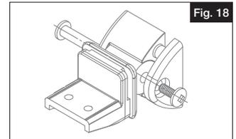
Ajuste el soporte superior de la escalera para que coincida con el ángulo de la escalera. Alinee la viga superior con los soportes y marque ambos extremos (Fig. 19). Realice un corte en estas marcas y compruebe si encaja bien.
