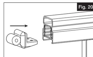
Appuyer sur les couvercles de main courante aux deux extrémités de la main courante. Faire glisser les supports du haut de l'escalier aux extrémités de la main courante (Fig. 22). Veiller à ce que les couvercles de main courante s'emboîtent dans les rainures des supports. Aligner le support, la main courante et le couvercle.
