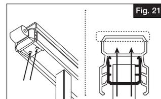
Pour chaque support, enfoncer deux vis à tête cylindrique peintes no 8 x  $1\frac{1}{8}$  po (41,3 mm) dans les avant-trous pour bloquer ensemble le support, le profilé supérieur et la main courante. Une fois que la main courante est fixée aux deux extrémités, faire glisser les supports dans les bases des poteaux et bloquer l'assemblage au moyen des couvercles de base et des boulons à charnière fournis.
