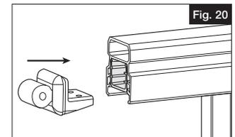
Presione las cubiertas del travesaño superior sobre los dos extremos del travesaño superior. Introduzca los soportes superiores de la escalera en su lugar en los extremos del travesaño superior (Fig. 22). Compruebe que las cubiertas del travesaño superior aniden en las ranuras de los soportes. Alinee el soporte, el travesaño superior y su cubierta.
