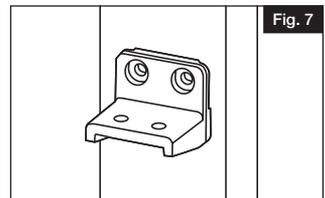
**NOTE:** La quincaillerie de montage comprise dans les kits de support est composée de (8) vis 1 1/2 po (38,1 mm) et de (4) vis 1 po (63,5 mm). On doit s'assurer d'utiliser les vis de 1 1/2 po (38,1 mm) pour l'installation des supports sur le poteau et de conserver les vis plus longues de 1 po (63,5 mm) pour l'installation de la main courante. Les vis plus longues de 1 po (63,5 mm) sont spécialement conçues pour bloquer la main courante en place à la fin de l'installation.
