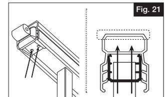
En cada soporte, coloque dos tornillos de cabeza troncocónica pintados #8 de  $1\frac{1}{8}$ " a través de los agujeros con lo que se fija el soporte, el canal superior y el travesaño superior entre sí. Una vez que el travesaño superior esté asegurado en ambos extremos, introduzca los soportes en las bases de los postes y fije el conjunto con las cubiertas de la base y los pernos de bisagra suministrados.
