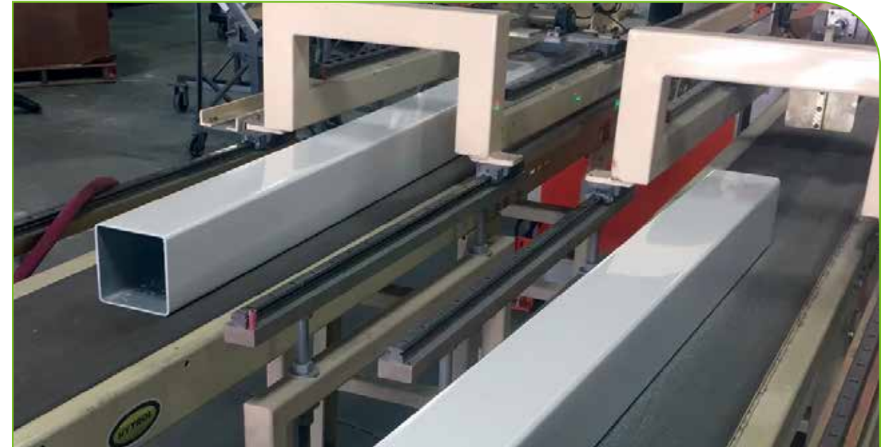
Material reciclable que se utiliza en las extrusiones de vallas de vinilo.
