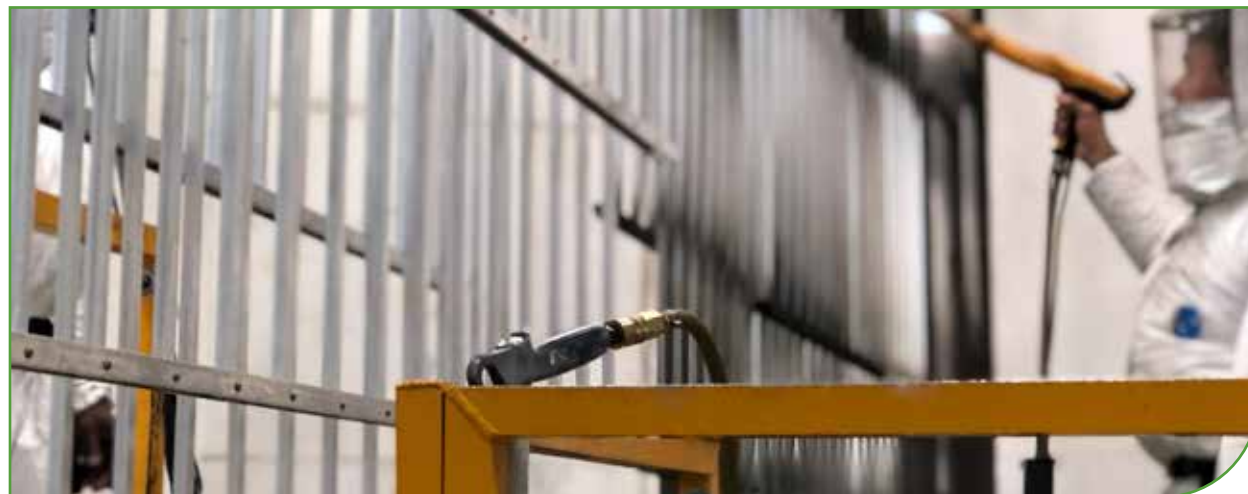
Aplicación de un recubrimiento en polvo a una valla de aluminio en Brooksville, Florida
