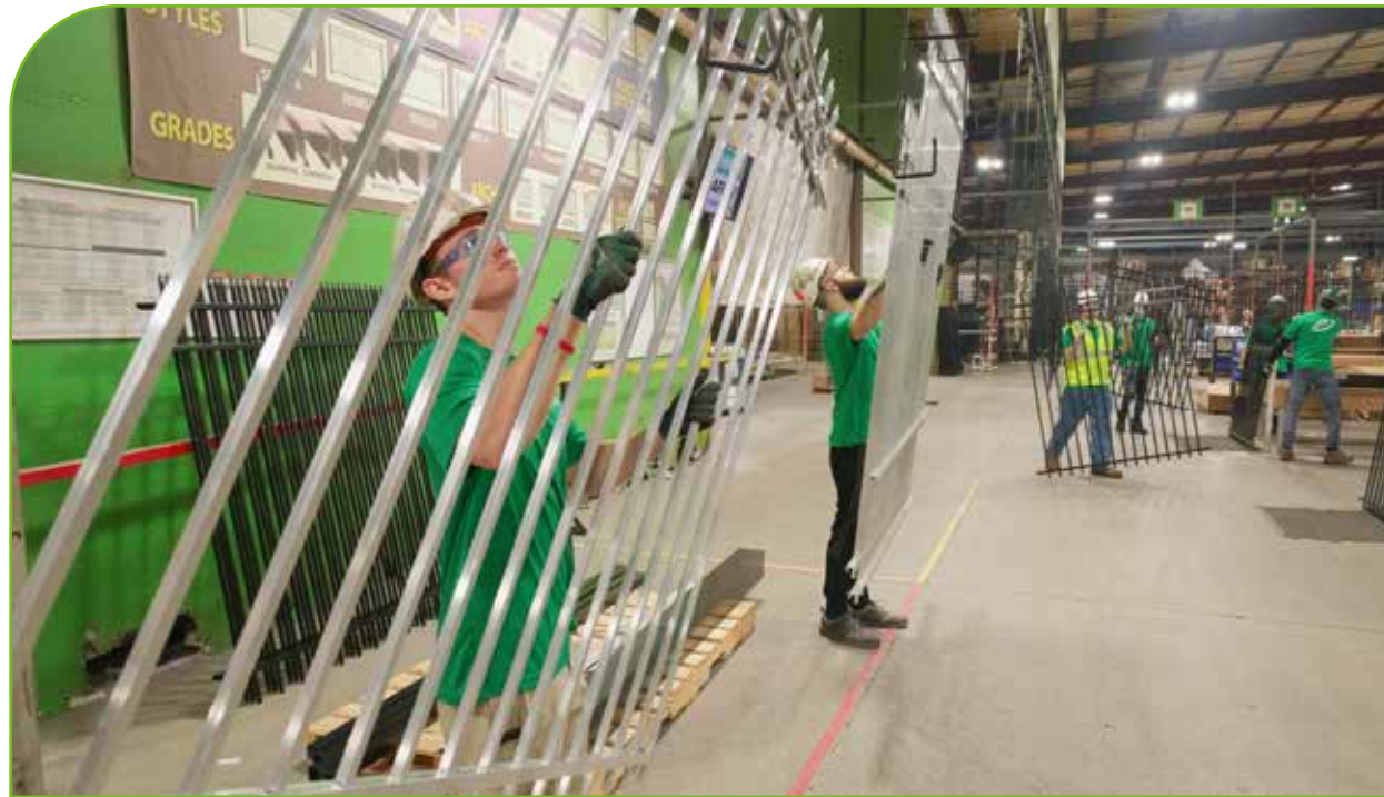
Los paneles de valla de aluminio se cargan en la estantería de recubrimiento en polvo en Brooksville, Florida
