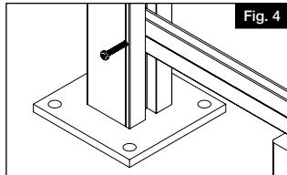
Ensuite, à l'aide de l'embout carré no 2 fourni dans le kit, insérer la vis dans les deux poteaux pour fixer les poteaux et les traverses ensemble. (Fig. 5). Retirer les cales d'écartement de 3 po (76 mm).
